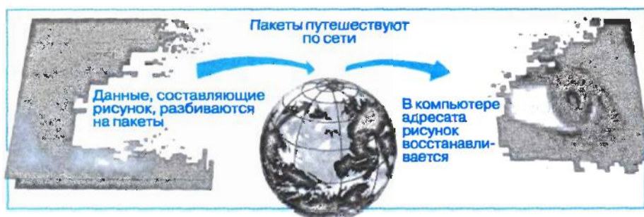
Рис. 6.5. Пакетная передача данных
