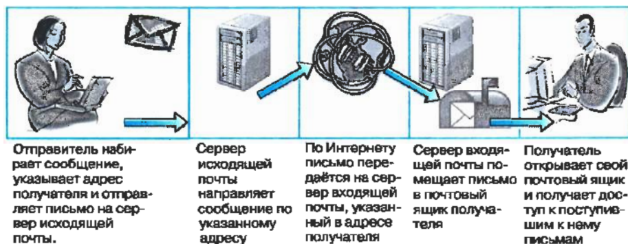
Рис. 6.6. Схема работы электронной почты
